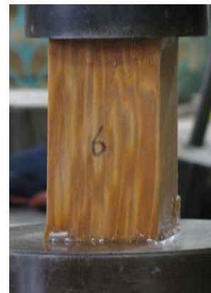
写真4. 飽水試験体の破壊
