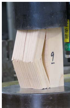
写真3. 乾燥試験体の破壊
