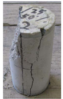
写真2. 試験体の横滑り 写真3. 縦の割れによる破壊
