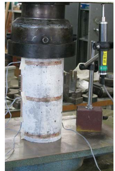
写真1. 圧縮試験の概要と横ひずみ度ゲージ位置
