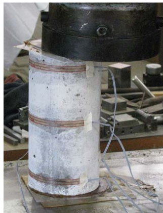
写真2. 試験体の横滑り 写真3. 縦の割れによる破壊
