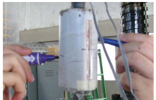
写真1. 鉄筋の変位によるひび割れ
